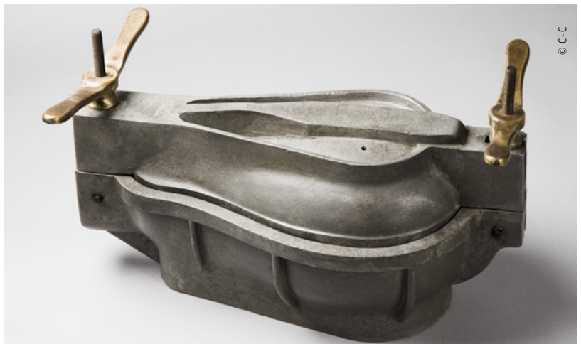
Stampo nel quale il prosciutto disossato è immerso in una salamoia con aromi e conservanti: questo processo è in parte responsabile dell'azione cancerogena degli insaccati
